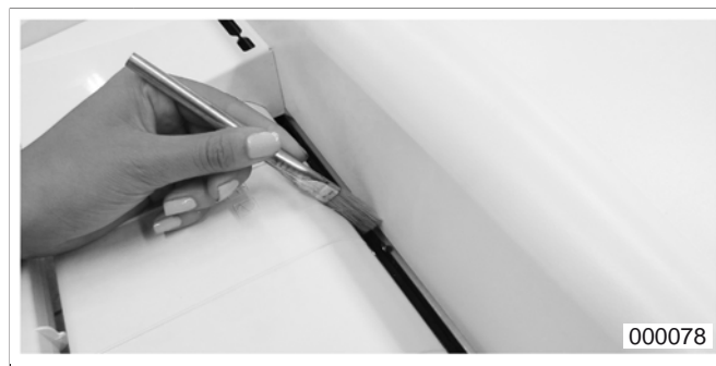
fig. 7 Nettoyage des cellules photoélectriques
