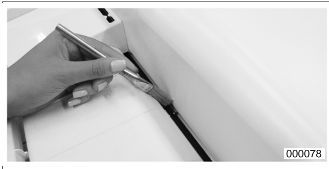
Fig. 7 Limpieza de las fotocélulas
